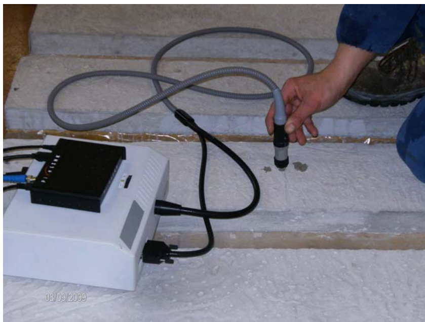
Fig. 5 - Rilevamento delle microfessure con l'ausilio di una sonda collegata a un microscopio ottico.
